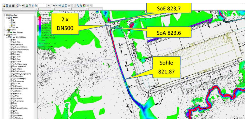
Abb.: Abflussmulde (West) entlang der Kreisstraße OAL8
