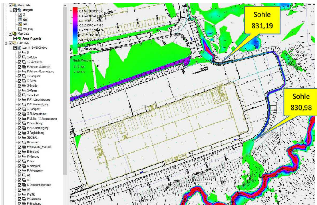
Abb.: Abflussmulde (West) entlang der Kreisstraße OAL8
