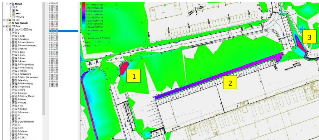
Abb.: Versickerungsmulden 1 bis 3 auf dem Baugrundstück des Hochregallagers
